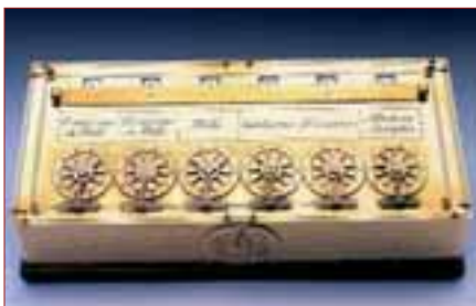
In alto: ricostruzione di Pascalina decimale
