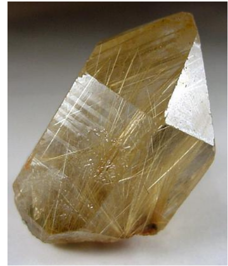
Quarzo \alpha , \text{SiO}_2 , trigonale
