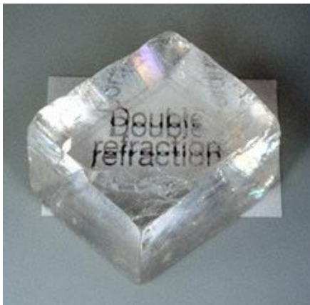
Birifrazione della calcite: formazione di due immagini di un oggetto
