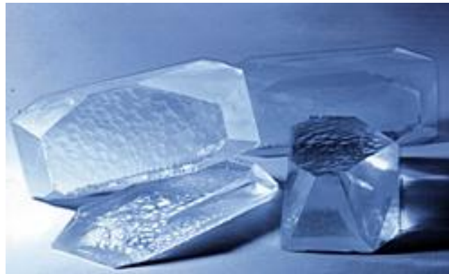
Monocristalli sintetici di quarzo purissimo
